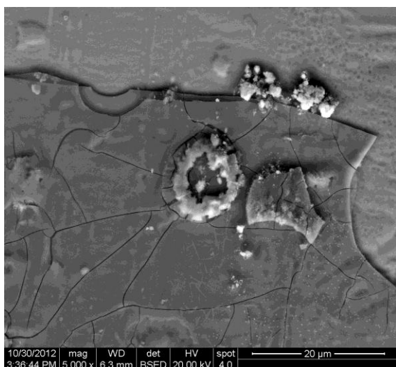
Рис. 7. Оксидная пленка на поверхности нанокристаллического сплава АМАГ-200
